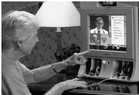
Εικ. 2. Σύστημα κατ' οίκον τηλε-παρακολούθησης και αποστολής μετρήσεων αρτηριακής πίεσης (αριστερά ασθενής στην οικία του, δεξιά Μονάδα Τηλε-παρακολούθησης Νοσοκομείου «ΣΩΤΗΡΙΑ»).
